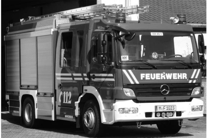
verfügt das Fahrzeug über eine umfangreiche Ausstattung zum Löschen von Bränden und zur technischen Hilfeleistung (z.B. 5 Pressluftatmer, Wärmebildkamera, Generator 13 kVA, Spreizer, Schere, Hebekissen, Motorsägen, Leitern, Tauchpumpe, E-Sauger usw.). Das HLF rückt in der Regel bei allen Einsätzen als erstes aus.
