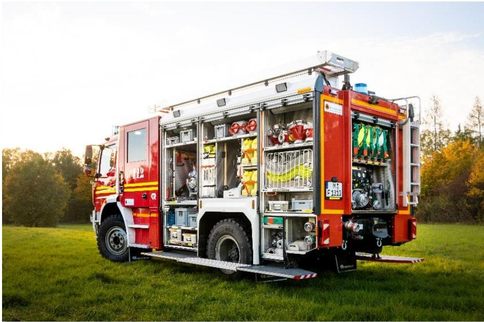
Im Jahr 2020 erhielt die Freiwillige Feuerwehr München drei baugleiche Löschgruppenfahrzeuge vom Bundesamt für den Katastrophenschutz. Es handelt sich dabei um ein 13,5 t Mercedes Atego Fahrgestell mit 272 PS und permanentem Allradantrieb. Der Aufbau stammt von der Firma Rosenbauer. Im Fahrzeug sind eine
