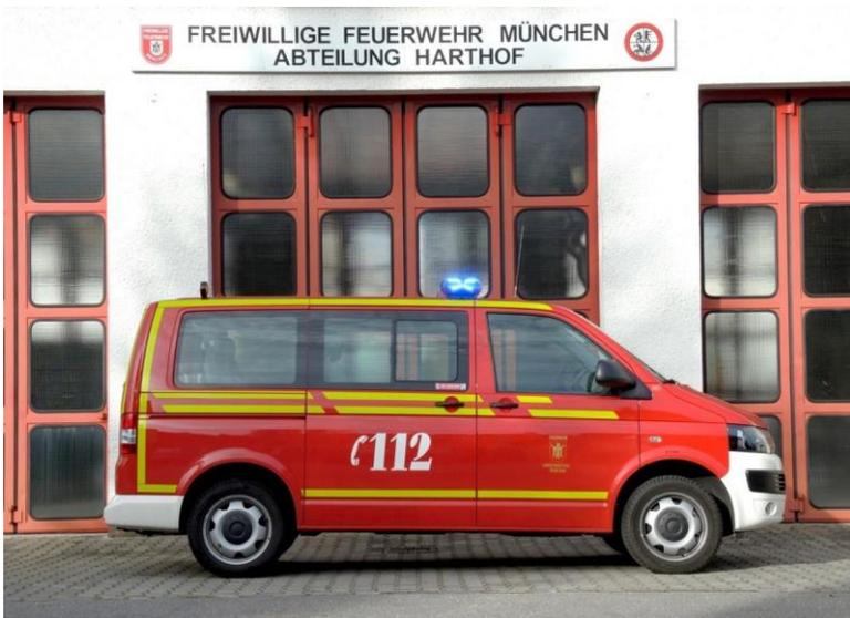
Unser MZF Bj. 2015 ist aus einer Beschaffungsserie von 11 baugleichen Fahrzeugen für die FF München. Es handelt sich um einen VW T5 Transporter mit 9 Sitzplätzen, einer Leistung von 132 KW/180 PS und Automatikgetriebe. Die Ausrüstung besteht aus einem Feuerlöscher, einer Erste-Hilfe-Ausrüstung und Material zur Verkehrsabsicherung. Der „VW-Bus“ dient zum Mannschaftstransport im Einsatzfall, dem Transfer zu und von Lehrgängen, der Vorbereitung von Übungen und wird von der Jugendfeuerwehr genutzt.
